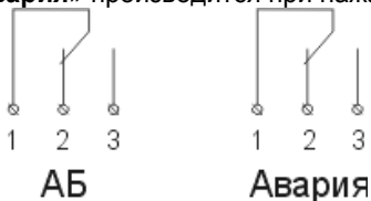
Рис. 5 Сухие контакты ИБП
